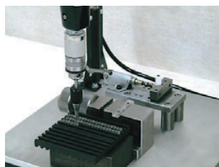
① 治具を回転させながらイリサートを治具の先端に装着
