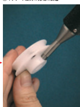
① 治具を回転させながらイリサートを治具の先端に装着
